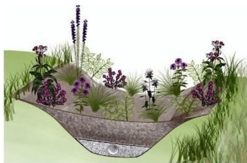
Coupe d'un jardin de pluie avec drain
